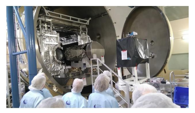
L'impressionnante cuve de 5 m de diamètre
