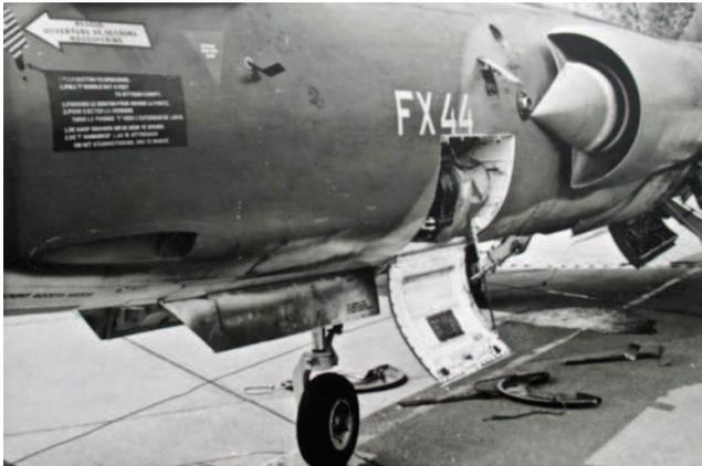
En mai 1978, le SIA est appelé à la Base du 1 Wing à Beauvechain pour une enquête suite à un incident survenu sur un canon M61 Vulcan à 6 tubes de calibre 20 mm d'un F-104 Starfighter (photo de logement).
