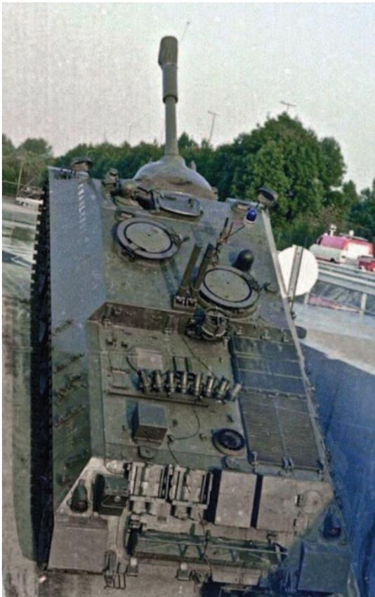
*... et le JPK (Jagdpanzer Kanone) de 28 tonnes franchissant avec succès la pente de la piste d'essai*
