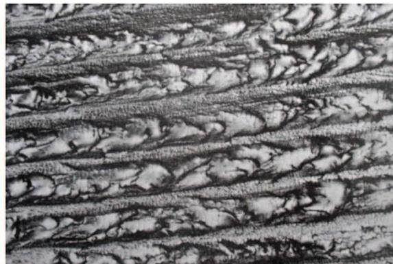
Affouillements et érosion d'un tube L7A1 de Léopard en fin de vie
