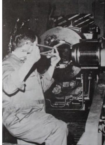
Mesure diamétrale d'un tube d'un M110 A2
